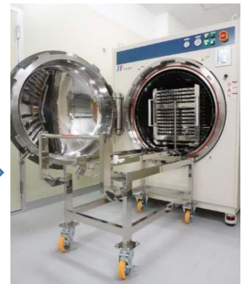
ラックをチャンバーへスライド投入 Slide the rack into the chamber
